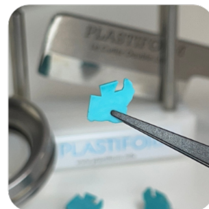
Exemple d'utilisation du P25 pour du contrôle dimensionnel
