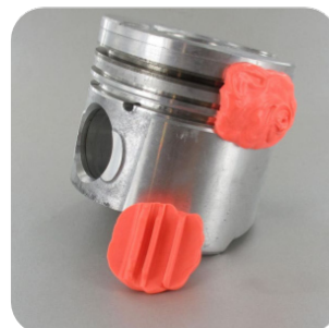
Exemple d'utilisation du P51 SD pour du contrôle de dimensions avec contact
