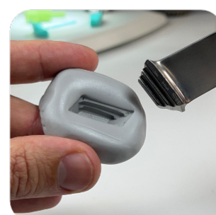
Exemple d'utilisation du M70 pour du contrôle de profil
