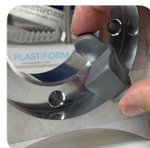
Exemple d'utilisation du M90 pour du contrôle de forme partielle
