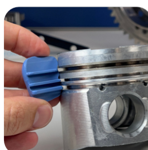
Exemple d'utilisation du M80 Lp pour du contrôle de profil
