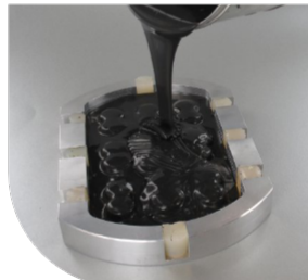
Exemple d'utilisation du F50 XL pour réaliser un moule de masquage sur mesure.
