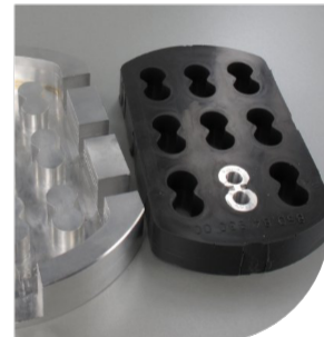
Exemple d'utilisation du F50 XL pour réaliser un moule de masquage sur mesure.
